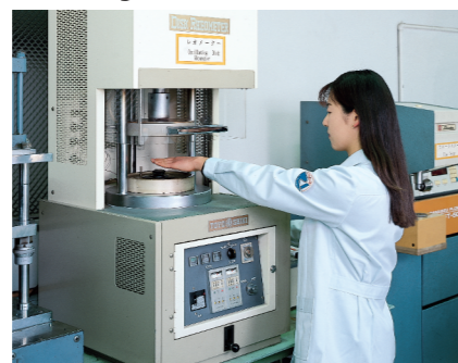
ODR (レオメーター) Oscillating Disk Rheometer
